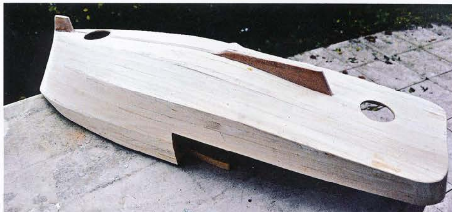
Vue des emplacements des propulseurs.
