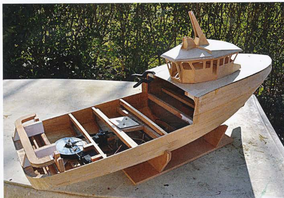
La passerelle positionnée sur pont avant.
