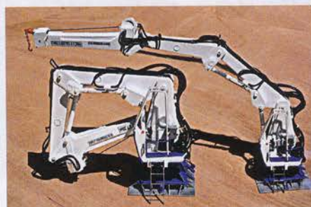
Les grues de mise à l'eau.
